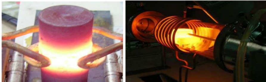
Рис. 2. Порівняння локального і об'ємного індукційного нагріву заготовок
