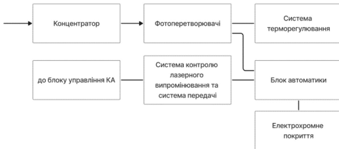
Рис. 4. Схема фотоприймальної системи на супутнику-приймачі
