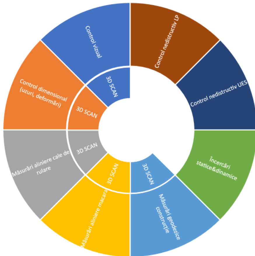
Fig. 1. Volumul examinării componentelor de macara
