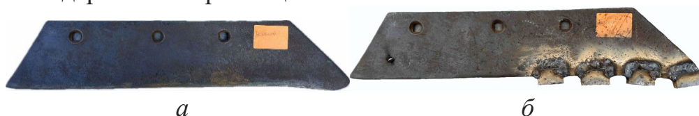
Рис. 5. Робочі органи ґрунтообробної техніки до (а) і після (б) відновлення
