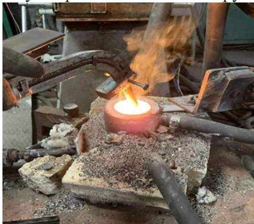
Рис. 4. Контрольований процес електрошлакового наплавлення
